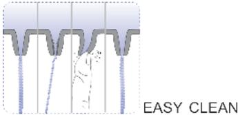
El sistema "easy clean", que permite eliminar los posibles restos de cal que pudieran formarse en la teleducha, con solo remover las salidas de agua manualmente.
