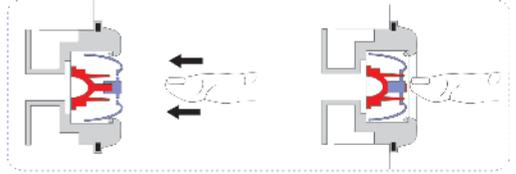
Los jets están equipados con un dispositivo antical, que con solo presionar el jet hacia el interior se desprenderán los posibles restos de cal que pudieran formarse.
